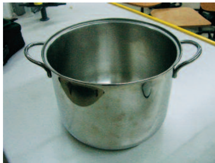
Figura 4. Pentola in acciaio inox per realizzare il corpo della camera a vuoto ed il tappo.
